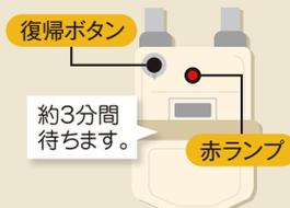
約3分間待ちます。(この間はガスを使わないでください。ガス漏れがないかマイコンメーターが確認しています。) 3分経過後に赤ランプの点滅が消えていれば、ガスが使えます。
