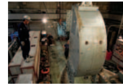
1.2GeV電子シンクロトロン電磁石の再整列及び改良のために撤去される大型測定器のLDM電磁石（写真左側に電子シンクロトロンがある）
